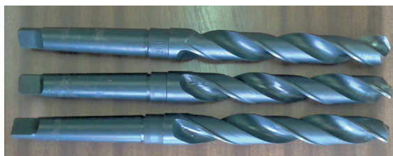
Obr. 3: Vrtáky \varnothing 21 použité pri vrtaní
