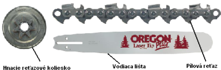
Obrázok 1 Reťazový rezací mechanizmus motorovej píly.
