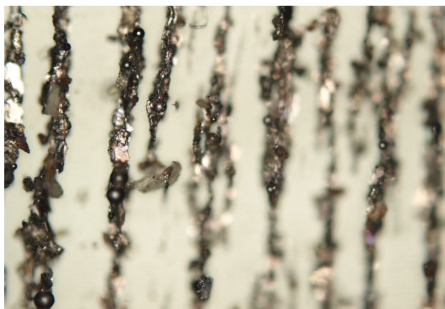
Obrázok 2 Veľké množstvo sférických ložiskových únavových častíc v pozícii „L“ a v hornej časti obrázku prítomnosť abrazie
