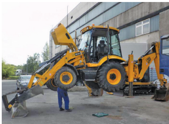
Obrázok 1 Odber vzorky motorového oleja zo stroja JCB 3CX
