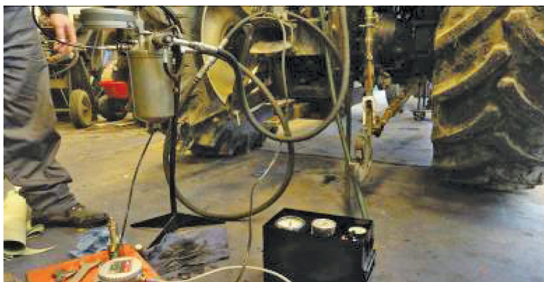
Obrázok 8 Pripojenie filtračného zariadenia, prístroja Owatonna a optického prístroja CS 1000 k vonkajšiemu okruhu hydrauliky traktora
