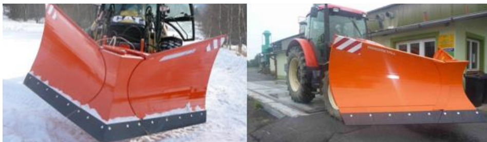
Fig. 2 Arrow snow ploughshare ( www.agra.sk )
