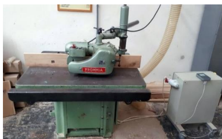
Fig. 4 Lower spindle milling machine FVS and feeder Frommia ZMD 252/137 Obr. 4 Spodná vretenová frézka FVS s podávacím zariadením Frommia ZMD 252/137
