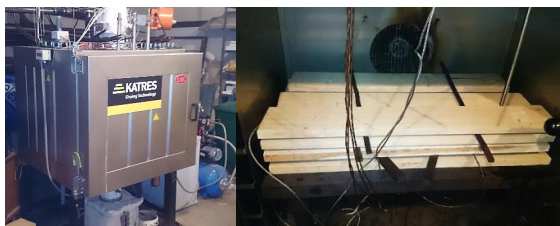
Fig. 2 Chamber S400/03 and samples prepared for thermal modification Obr. 2 Komora S400/03 a pripravené vzorky na tepelnú úpravu
