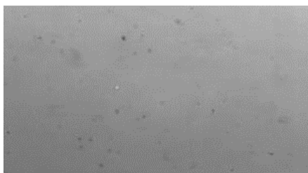
Fig. 2. Wear particles in a sample of new oil Obr. 2. Častice opotrebenia vo vzorke nového oleja
