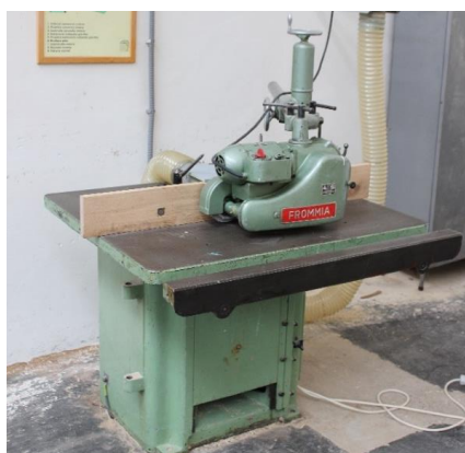
Fig. 2 Lower Spindle Milling Machine with attached Feeder Obr. 2. Spodná vretenová frézka s upevneným podávacím mechanizmom
