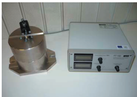
Obr. 5 Dynamometer so zosilňovačom (Foto Javorek)
