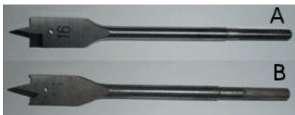
Obr. 4 Vrtáky (Balko, 2011) (A – bez predrezávačov, B – s predrezávačmi)
