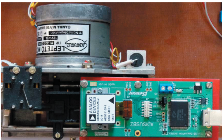
Obrázok 6 Umiestnenie MEMS 16355 na vývojovej doske ADIS USB-ND
