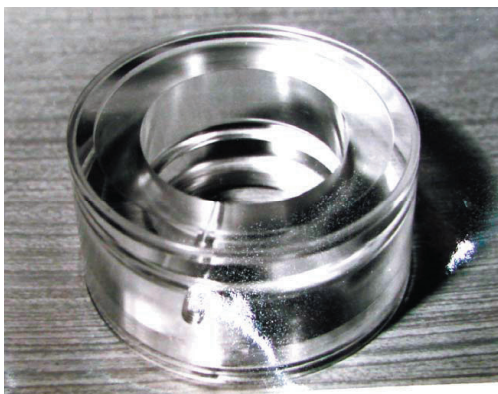
Obr. 2 Ložisko z plexiskla
