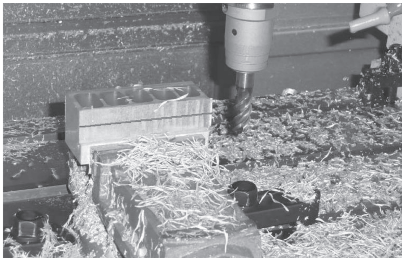
Obrázok 2 Upnutie a frézovanie vzorky (čiara na obrobnku znázorňuje líniu, v ktorej sa merala drsnosť povrchu)
