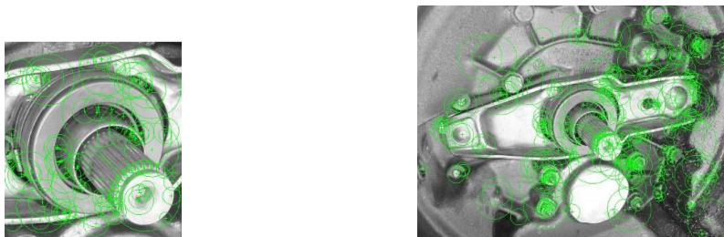
Obr. 3. Vygenerované body pre identifikáciu Fig. 3. Generated points for the identification a) Vygenerovaných 100 bodov (100 generated points), b) Vygenerovaných 300 najsilnejších bodov zo zostavy (The strongest 300 generated points from the setting)
