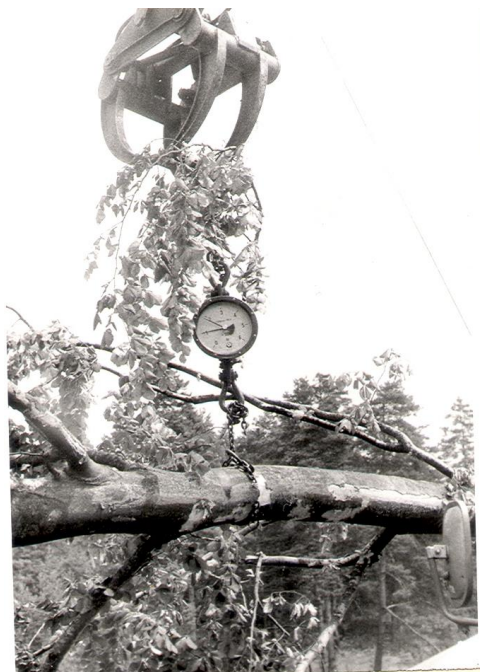
Obr. 2 Zisťovanie ťažiska a hmotnosti stromov Fig. 2 Determination centre of gravity and weight trees
