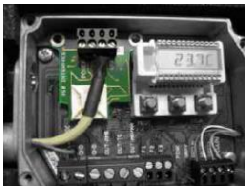
Obr. 3. Vyhodnocovacia jednotka s osadenou doskou USB rozhrania Fig. 3. Evaluation board with USB communication interface
