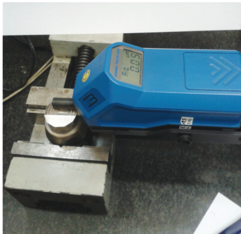
Obrázok 3 Meranie drsnosti pomocou dotykového profilomera
