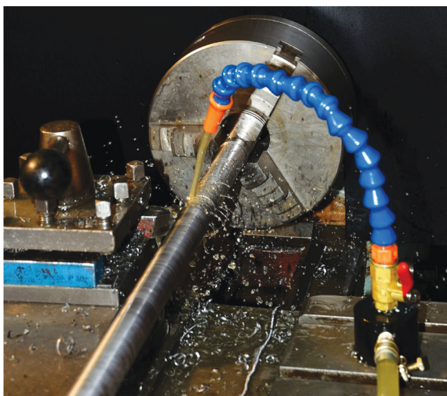
Obr. 2 Detailný pohľad na tvorbu kvapiek a ligamentov
