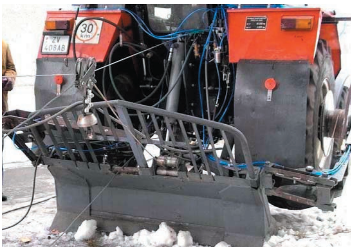
Obrázok 1 Navrhnutý traktorový lanový systém s nekonvenčným pohonom
