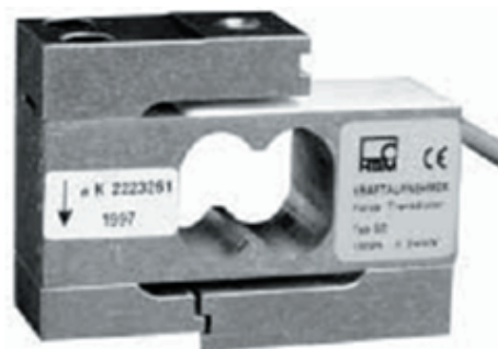
Obr. 9 Snímač trecieho momentu S2 20N Fig. 9 Sensor of frictional moment S2 20N
