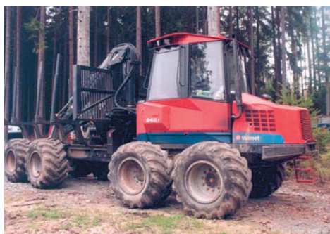
Obr. 3 Vyvážecí traktor Valmet 840.1 Fig. 3 Forwarder Valmet 840.1
