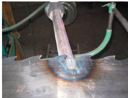
Obr. 2 Zariadenie na žihanie zvar. spojov
