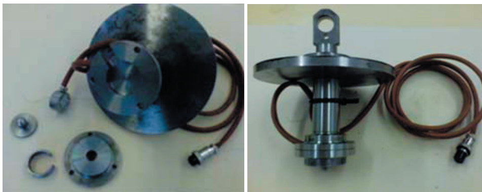
Obr. 5 Uloženie snímača zaťažujúcej sily Fig. 5 Suspension of normal force sensor
