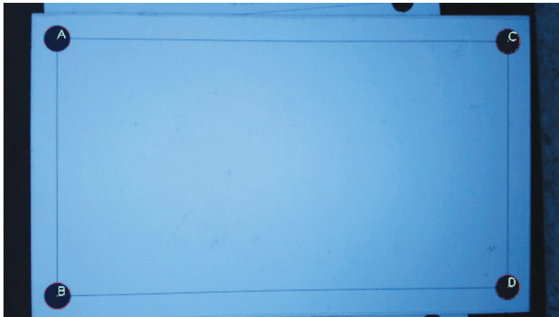
Obrázok 4 – Kalibračná doštička nasnímaná kamerou
