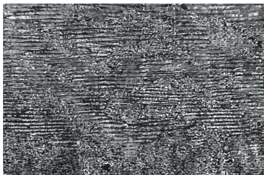
Obrázok 1 Fotografia zuhoľnatia reznej špáry (zväčšenie 200 \times , rýchlosť rezania 12 \text{mm}\cdot\text{s}^{-1} , 150 W, 250 kPa)
