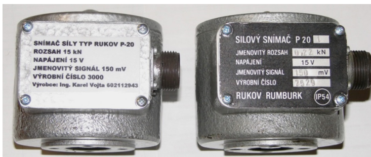
Obr. 2 – Používané snímače a) snímač tlakovej sily (1) b) snímač trecej sily (2)
