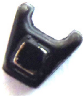
Obrázok 4 Mikrorobot s rozmermi 4 \times 4 \times 1 mm
