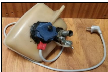
Fig. 3 Heater with a spiral of 500W Obr. 3 Ohrevné těleso so špirálou o výkone 500W
