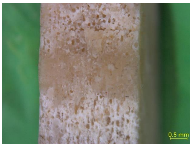
Fig. 3 Fracture surface of the test specimen Obr. 3 Lomová plocha skúšobnej vzorky
